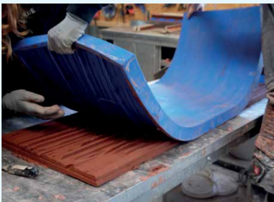
Na 5 minuten is de plaat droog, en kan hij uit de mal worden gehaald.
